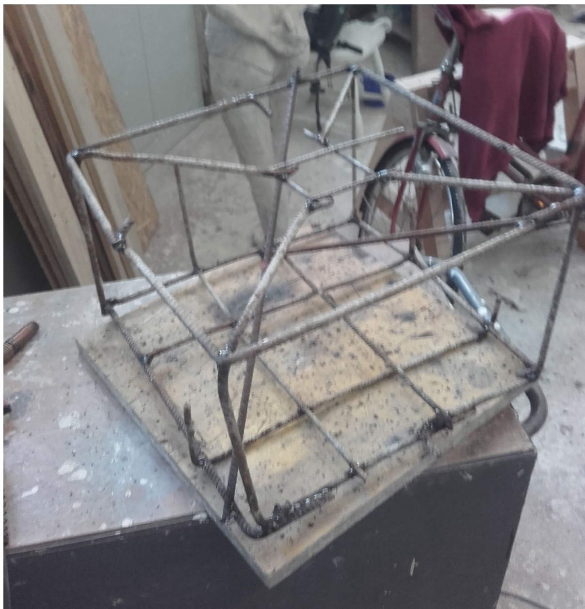
Slika 7: Varjenje armature za betonski temelj. (foto: Doroteja Erhatic, 2018)
